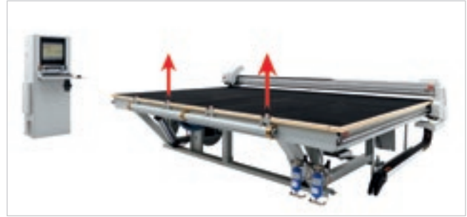
可伸缩的支撑脚能自动地从工作台面伸出
