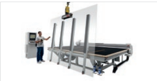
操作员手动将玻璃片加载到翻转臂上
